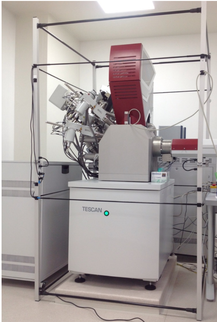
Beispiel einer Testmessung zur Magnetfeldreduktion mit einer mobilen Helmholtzspulenanordnung
